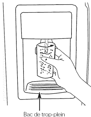
Bac de trop-plein
